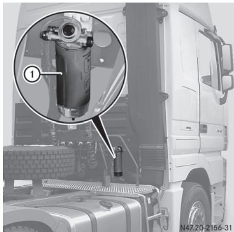
Kraftstoff-Vorfilter an der Rückwand (Beispiel)
