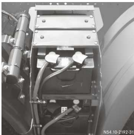
Batterieträger seitlich am Fahrgestell – Batterien übereinander angeordnet (Beispiel)
